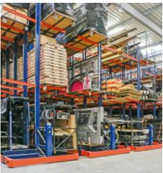
KÖNNEN AUF MOBILEN VERFAHRWAGEN MONTIERT WERDEN, UM DIE LAGERKAPAZITÄT ZU ERHÖHEN.
