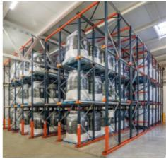
ARBEITEN NACH DEM LIFO-SYSTEM (*LAST IN, FIRST OUT*) ODER DEM FIFO-SYSTEM (*FIRST IN, FIRST OUT*) NACH CHARGEN, WENN MEHR ALS DREI LADESTRASSEN PRO ARTIKEL VERFÜGBAR SIND.
