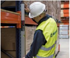
UNSERE TECHNIKER FÜHREN EINE GENAUE INSPEKTION DER ANLAGE DURCH UND ÜBERPRÜFEN DEN ZUSTAND DER REGALE UND DES LAGERS ALLGEMEIN. © 02133 5065 0 | # mecalux.de
