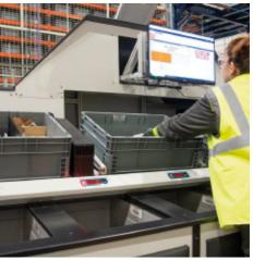
PICK-TO-LIGHT-GERÄTE BESCHLEUNIGEN DIE KOMMISSIONIERUNG UND VERMEIDEN FEHLER, DIE DURCH MANUELLE HANDHABUNG VERURSACHT WERDEN KÖNNEN.
