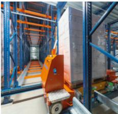
IN KOMBINATION MIT REGALBEDIENGERÄTEN ERREICHT DAS PALLET-SHUTTLE-SYSTEM EINE LAGERHÖHE <u>VON BIS ZU 40 M.</u>
