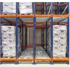
GESCHWINDIGKEIT UND SICHERHEIT DER VORGÄNGE, DA DIE GABELSTAPLER NICHT IN DIE REGALE EINFAHREN MÜSSEN UND NUR VON EINEM GANG GEARBEITET WIRD.
