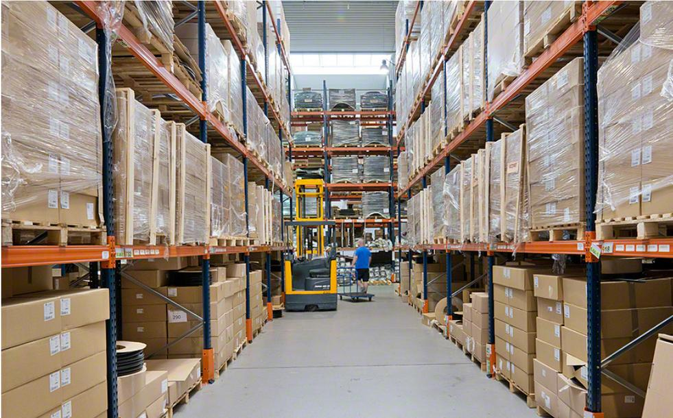
Design ist an die Eigenschaften der Produkte angepasst, die länger als die Paletten sind. Diese Regale sind 4 m hoch und verfügen über fünf oder sechs Ebenen, auf denen Produkte von mehr als 4 m Länge und einem maximalen Gesamtgewicht von 3500 kg gelagert werden können.
