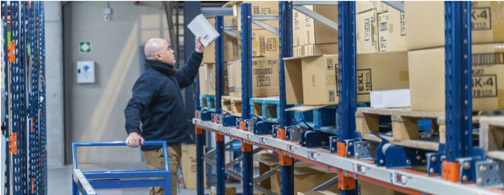
**Der Lagerarbeiter folgt den Anweisungen von Easy WMS beim Entnehmen und Klassifizieren der Ware in einem Wagen mit vier Lagerpositionen, jeweils eine für jeden Auftrag**
