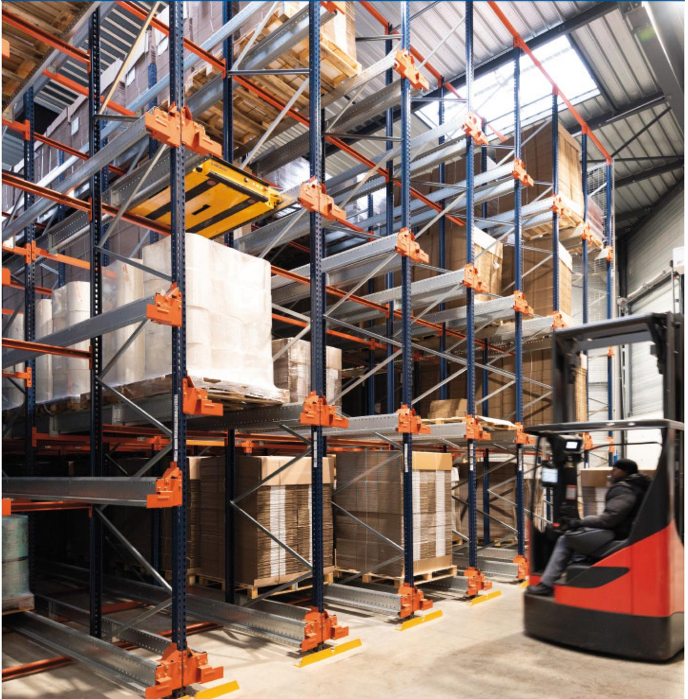
Les Mille Et Une Feuilles, ein französischer Hersteller von Brick-Teig, hat ein neues Lager mit Einfahrregalen und dem Pallet-Shuttle-System von Mecalux eingeweiht. Diese Anlage hat zwei Funktionen: einerseits den Transport der Rohstoffe in den Produktionsbereich und andererseits die Lagerung der Fertigprodukte. Die halbautomatisierte Lösung mit dem Pallet Shuttle sorgt für große Schnelligkeit bei der Ein- und Auslagerung der Produkte.
