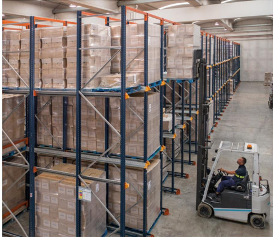
Die Ladegassen verfügen über Stützschiene in Dreiecksform auf beiden Seiten, die nur eine geringe Höhe einnehmen und das Absetzen und die Lagerung der Paletten erleichtern
