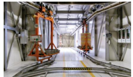
Am Ende des Kreislaufs wurde ein Wartungsbereich eingerichtet, in den die Wagen gebracht werden, bei denen bestimmte Maßnahmen erforderlich sind, und wo die Wagen in Wartestellung verbleiben.
