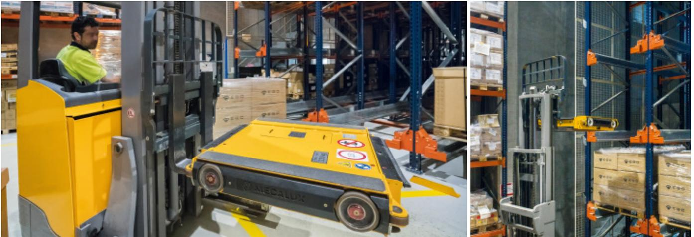
Dieser Vorgang wird so oft wie nötig wiederholt. Um die Ware zu entnehmen, wird der gleiche Vorgang, jedoch in umgekehrter Reihenfolge und vom entgegengesetzten Ende des Regalblocks aus, durchgeführt.
