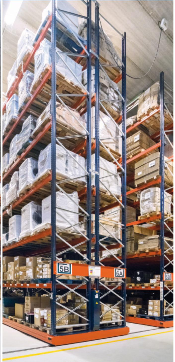
EGO Appliance Controls hat für ihr Lager in Lliçà de Vall (Barcelona) eine an ihre Bedürfnisse angepasste Lösung gefunden. Mecalux hat das Lager mit dem Kompaktsystem Pallet Shuttle, zwei Movirack-Regalblöcken und herkömmlichen Palettenregalanlagen ausgestattet.
