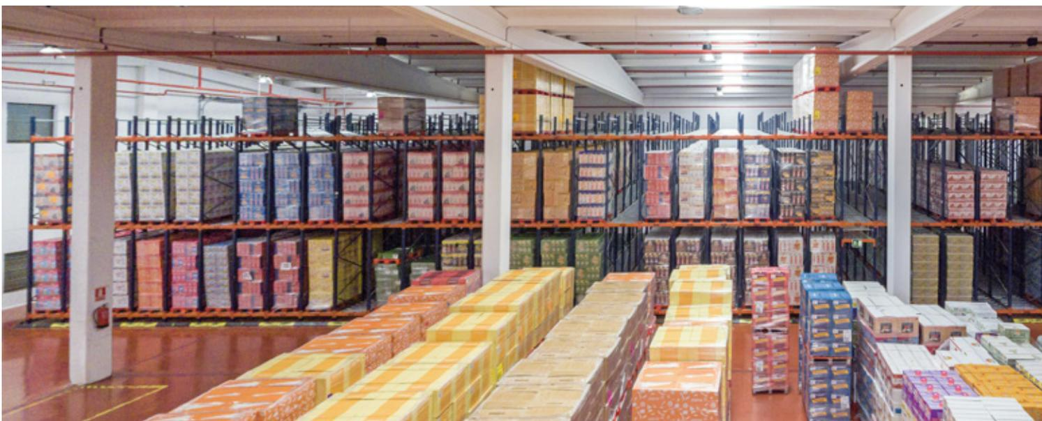
Kanäle gesetzt. Die Warenhandhabung erfolgt nach dem FIFO-Prinzip (*First In First Out*), d. h., die zuerst eingelagerte Palette wird zuerst entnommen, eine grundlegende Bedingung für Tosfrit.
