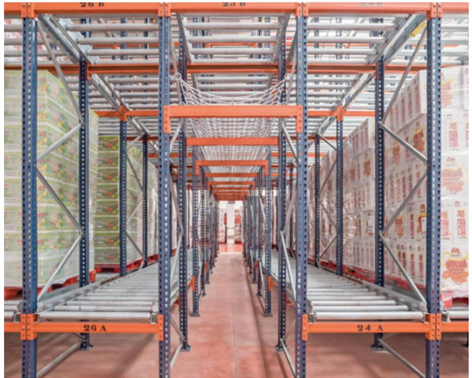
Die Kanäle der Regalanlage haben eine leichte Neigung und sind mit Rollen und Geschwindigkeitsreglern versehen, um eine kontrollierte Bewegung der Paletten zu gewährleisten
