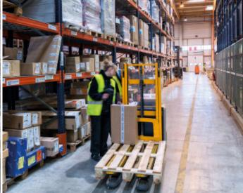
Die Niederhubkommissionierer werden für die Artikel auf der ersten Regalebene oder auf dem Boden eingesetzt, während die Hochhubkommissionierer den Zugang zur Ware auf den zwei oder drei oberen Regalebenen ermöglichen.
