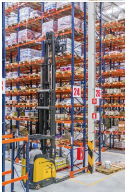
Daneben werden Palettenhubwagen eingesetzt, um die Ware direkt von den Paletten auf der unteren Ebene zu entnehmen. Die Kommissionierer durchlaufen das Lager und entnehmen die Produkte der jeweiligen Bestellung, die ihnen die Lagerverwaltungssoftware (LVS) über ein Funkterminal anzeigt.
