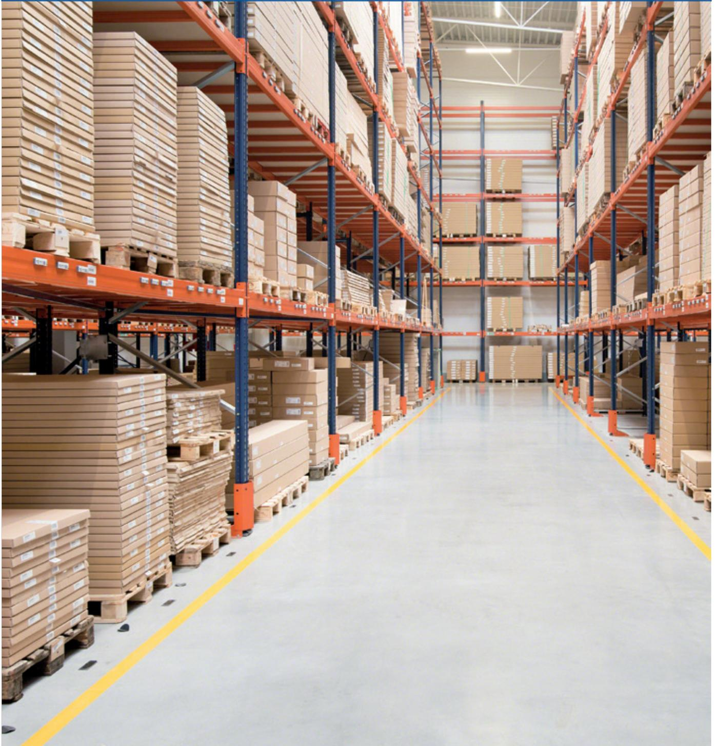
Mecalux hat in dem neuen Lager von Dolmar in Kepno (Polen) herkömmliche Palettenregalanlagen installiert. Dieses System bietet eine Lagerkapazität von 6445 Paletten mit großen Abmessungen und außerdem den direkten Zugang zur Ware, was die Lagerarbeiten beschleunigt.
