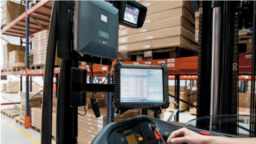
Um die Handhabung der Paletten zu erleichtern und mögliche Stöße gegen die Regalanlage zu vermeiden, besitzen die Gabeln der Stapler eine Kamera, deren Bilder auf einem Bildschirm in der Fahrerkabine angezeigt werden
