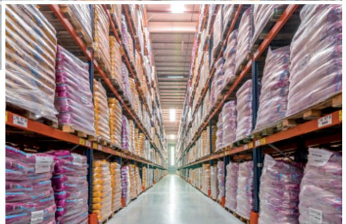
Mecalux hat das System mit herkömmlichen Palettenregalanlagen für zwei neue Lager geliefert, die Qbox in seinem Logistikzentrum in Argentinien errichtet hat. Insgesamt besitzt das Lager eine Kapazität für mehr als 29.500 Paletten. Diese Regalanlagen können Produkte mit verschiedenen Abmessungen und Eigenschaften aufnehmen und eignen sich zudem sehr gut für die Kommissionierung direkt von den Paletten.
