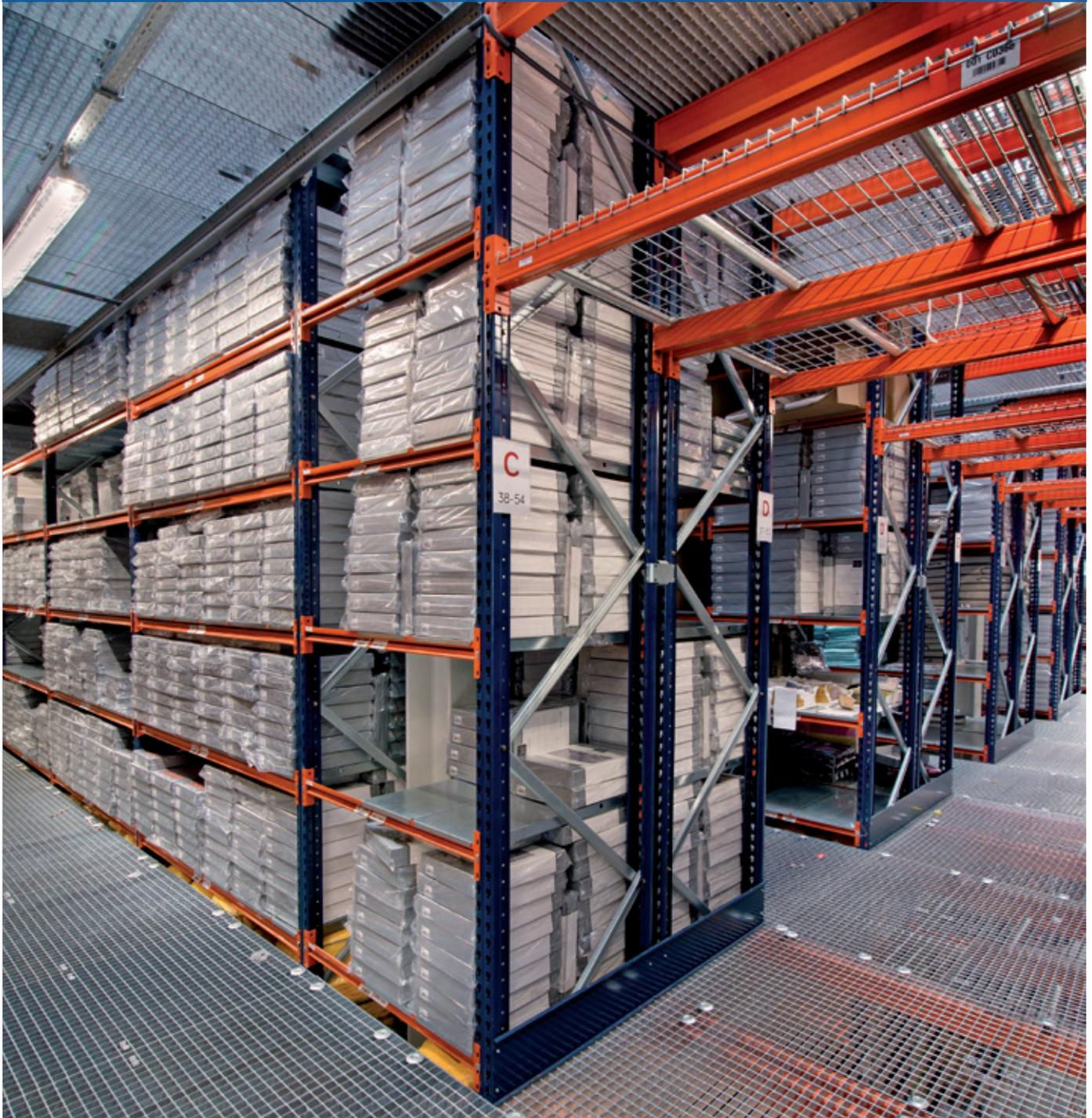
Mecalux hat alle Lagersysteme des neuen Lagers von Eurofirany in Żywiec (Polen) geliefert. Einerseits Regalanlagen mit Laufgängen, die aus insgesamt drei Ebenen bestehen, und andererseits Kragarmregale für Langgut. Das Ziel besteht bei beiden Lösungen darin, die Ware nach ihren Abmessungen und ihrer Nachfrage zu ordnen und die Lagerarbeiten und die Auftragszusammenstellung zu beschleunigen.
