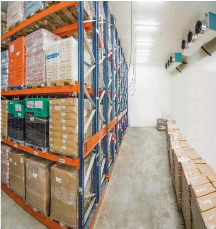
Nach Analyse der Bedürfnisse des Unternehmens rüstete Mecalux das neue Tiefkühlager mit fünf doppelten Movirack-Verschieberegalanlagen und zwei feststehenden Regalanlagen aus, die 8,8 m hoch und 34 m lang sind. Insgesamt wurde so eine Lagerkapazität für 1280 Paletten mit einem Höchstgewicht von je 1000 kg geschaffen.
