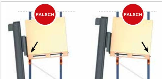
Abb. 9. Überlastung eines Längsträgers durch nicht horizontales Absenken
