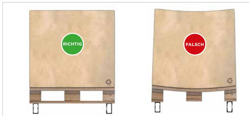
Es muss vermieden werden, dass sich die Last in der Mitte der Längsträger konzentriert, sei es durch die Positionierung oder Änderungen der Ladeeinheiten.
