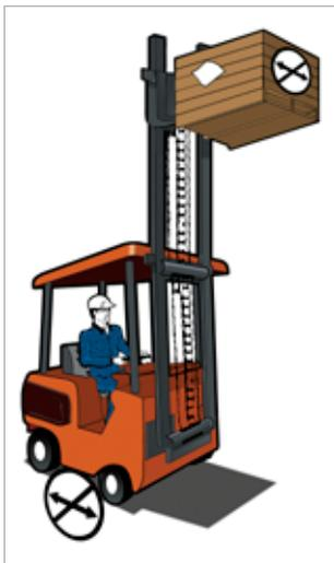
Abb. 1. Nicht mit angehobenen Lasten fahren
