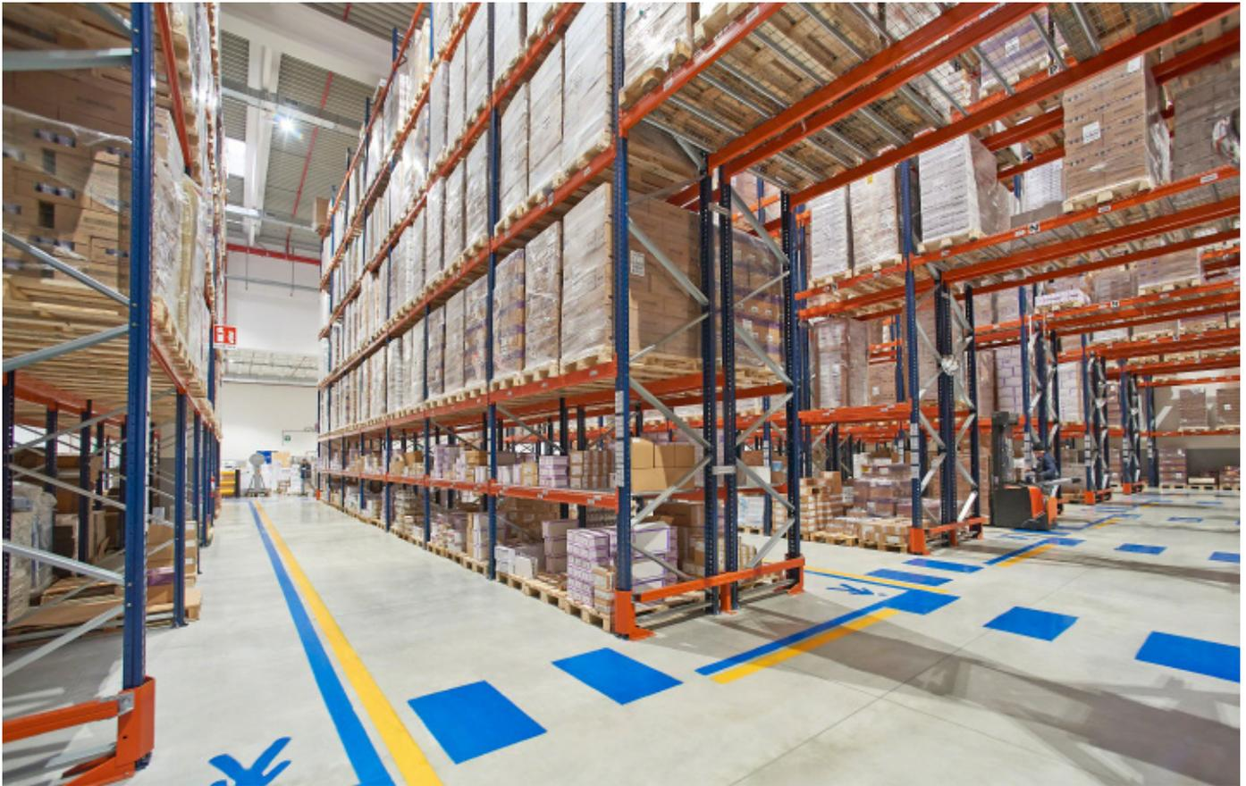
päische Norm EN 16681 berücksichtigt. Daher wurden die Regale speziell verstärkt, um möglichen seismischen Bewegungen in der Region standzuhalten. Gleichzeitig wurde das Lager in verschiedene Sektoren eingeteilt, um Produkte mit ähnlichen Eigenschaften (brennbar, reaktiv usw.) im gleichen Bereich zu lagern. In jedem Bereich herrscht eine bestimmte Temperatur, sodass die Arzneimittel gemäß ihren spezifischen Eigenschaften gelagert werden.
