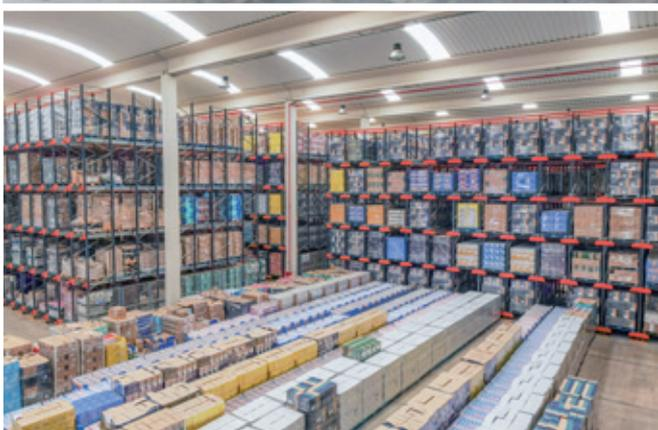
Das Logistikzentrum von Iberfrasa, einem Hersteller von Körperpflegeprodukten, wächst ständig weiter. Seit seiner Eröffnung im Jahre 2014 wurde es bereits sechsmal erweitert. Es ist mit Einfahrregalen mit dem Pallet-Shuttle-System ausgestattet, einer Lagerlösung, die die gesamte Fläche nutzt, um eine höhere Lagerkapazität zu erreichen, und die Produktivität durch die Optimierung der Bewegungen der Kommissionierer steigert.
