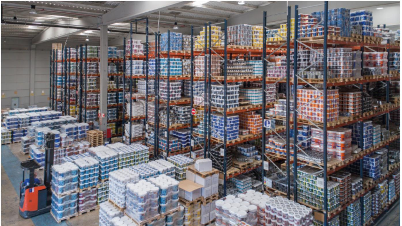
Angesichts dieser Faktoren hat Mecalux konventionelle Palettenregale montiert, die eine Gesamtkapazität von 4000 Paletten bieten. Dort werden die aus dem Produktionszentrum kommenden versandbereiten Fertigprodukte gelagert.
