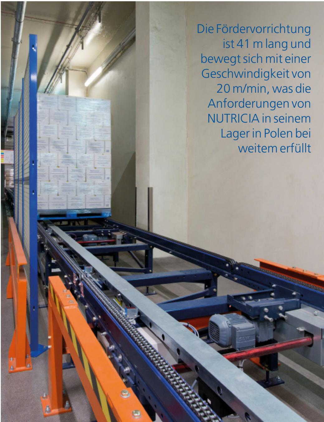
Die Fördervorrichtung ist 41 m lang und bewegt sich mit einer Geschwindigkeit von 20 m/min, was die Anforderungen von NUTRICIA in seinem Lager in Polen bei weitem erfüllt
