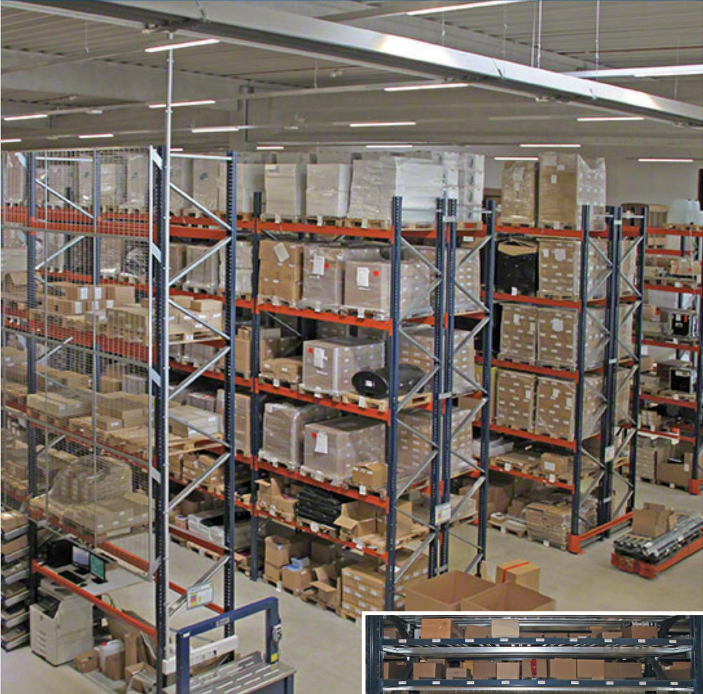
Mecalux hat das Lager von Company 4 Marketing Services in Neufahrn bei Freising (Deutschland) mit einem System herkömmlicher Palettenregalanlagen ausgestattet. Die Regalanlage bietet eine Lagerkapazität von 2253 Paletten und maximiert gleichzeitig die Leistung der wichtigsten Tätigkeit dieses Standorts: die Auftragszusammenstellung.
