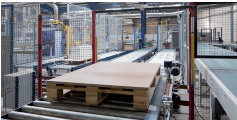
Mecalux hat einen fortschrittlichen Förderkreislauf im Produktionszentrum von Euréquip, einem französischen Möbelhersteller, installiert. Er hat die Aufgabe, die Ware durch die verschiedenen Prozesse zur Bearbeitung der Holzplatten für die spätere Möbelherstellung zu befördern. Dieses Transportsystem sorgt für einen raschen Transport der Ware zu der jeweiligen Position, an der der Vorgang durchgeführt wird.
