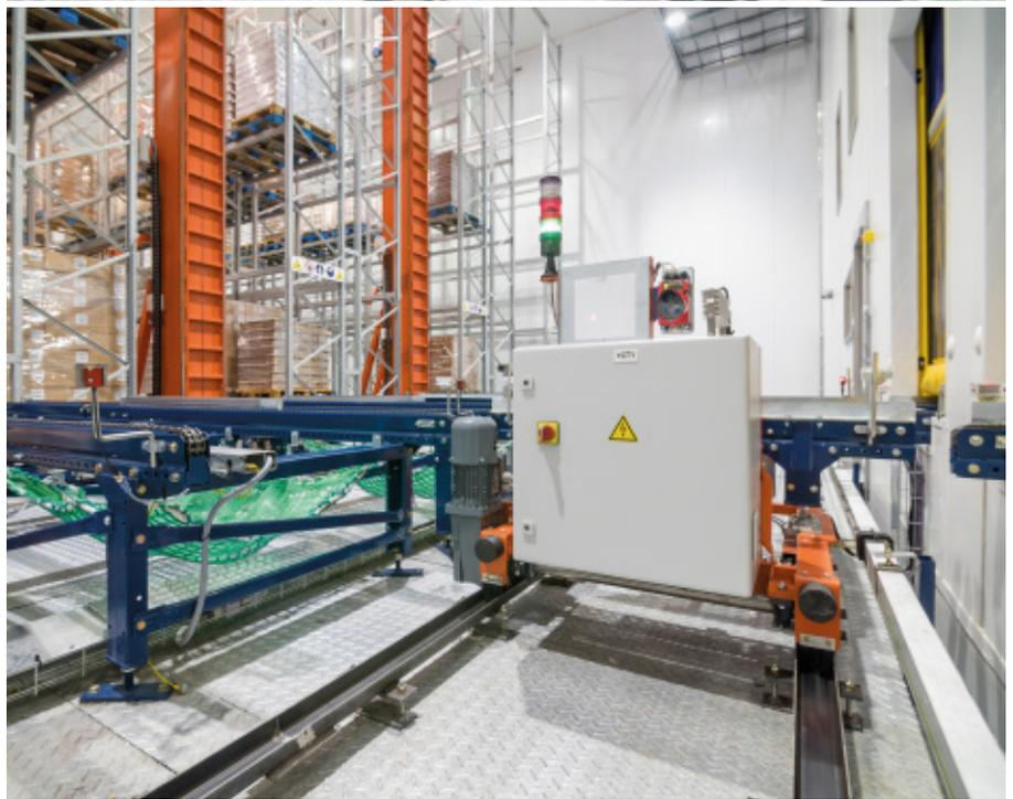
Nach erfolgreicher Kontrolle durchqueren die Paletten zuerst den Vorraum, bevor sie in das Lager gelangen. Dieser besteht aus einem Schleusensystem mit zwei vertikalen Schnellaufzügen, die niemals gleichzeitig offen sind. Dieses Eingangssystem schützt das Kühllager vor plötzlichen Temperatur- und Druckänderungen aufgrund des ständigen Passierens der Ladeeinheiten.
