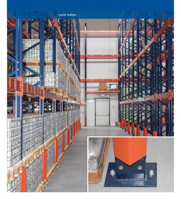
Citres, italienischer Konservenproduzent und -exporteur, hat in seinem Lager in Bovolone (Verona) erdbebensichere Regale von Mecalux mit einer Lagerkapazität von 3.200 Paletten installiert. Diese Einrichtung bietet Sicherheit bei der Lagerung von Lebensmitteln und sorgt für einen raschen und effizienten Ablauf, wodurch eine schnelle Zusammenstellung und ein zügiger Versand der Aufträge gewährleistet werden.
