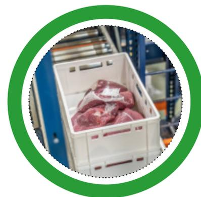
Die gesamte Anlage wurde so angepasst, dass zwei Behälter mit den Abmessungen 400 x 600 mm übereinander gelagert werden können
