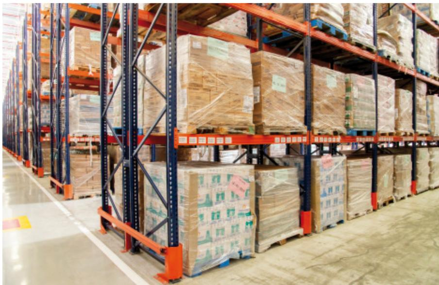
Auf den unteren Ebenen der Regale führen die Lagerarbeiter die Kommissionierung mithilfe von Niederhubkommissionierstaplern durch. Sie entnehmen die Behälter für die einzelnen Bestellungen direkt von den Paletten und gruppieren sie auf einer anderen Palette, mit der sie durch die Gänge fahren.
