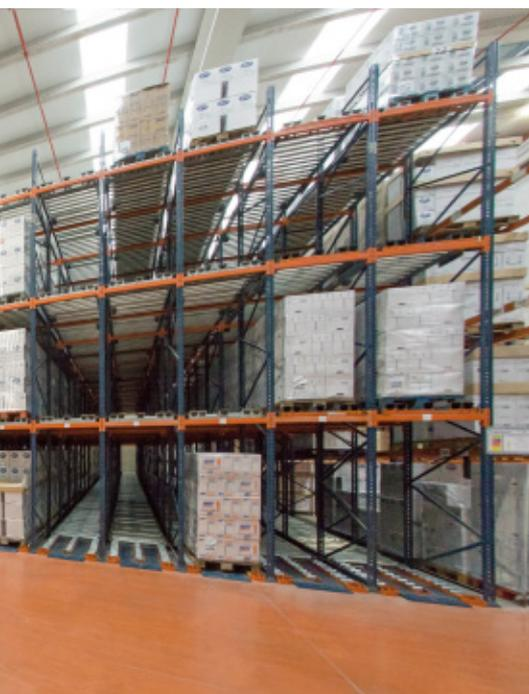
Die Regale bestehen aus einer Reihe von leicht geneigten Kanälen mit Rollen, auf denen sich die Waren mithilfe der Schwerkraft bewegen können.
