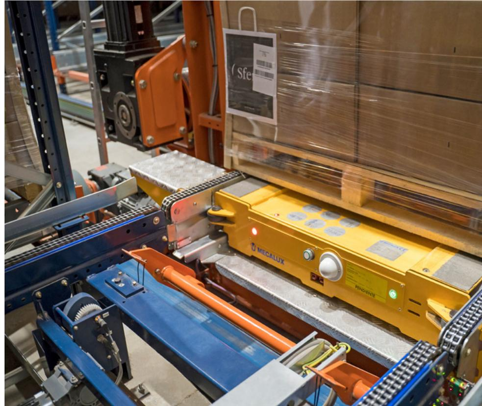
So entstand ein Lager, das aus zwei Blöcken mit 10 m hohen Regalen besteht, zwischen denen sich ein 45 m langer Gang befindet, in dem sich ein Regalbediengerät bewegt. Der eine Block umfasst fünf Paletten und der andere 33 Paletten in der Tiefe. Insgesamt können 4.990 Paletten mit einem maximalen Stückgewicht von 600 kg gelagert werden.
