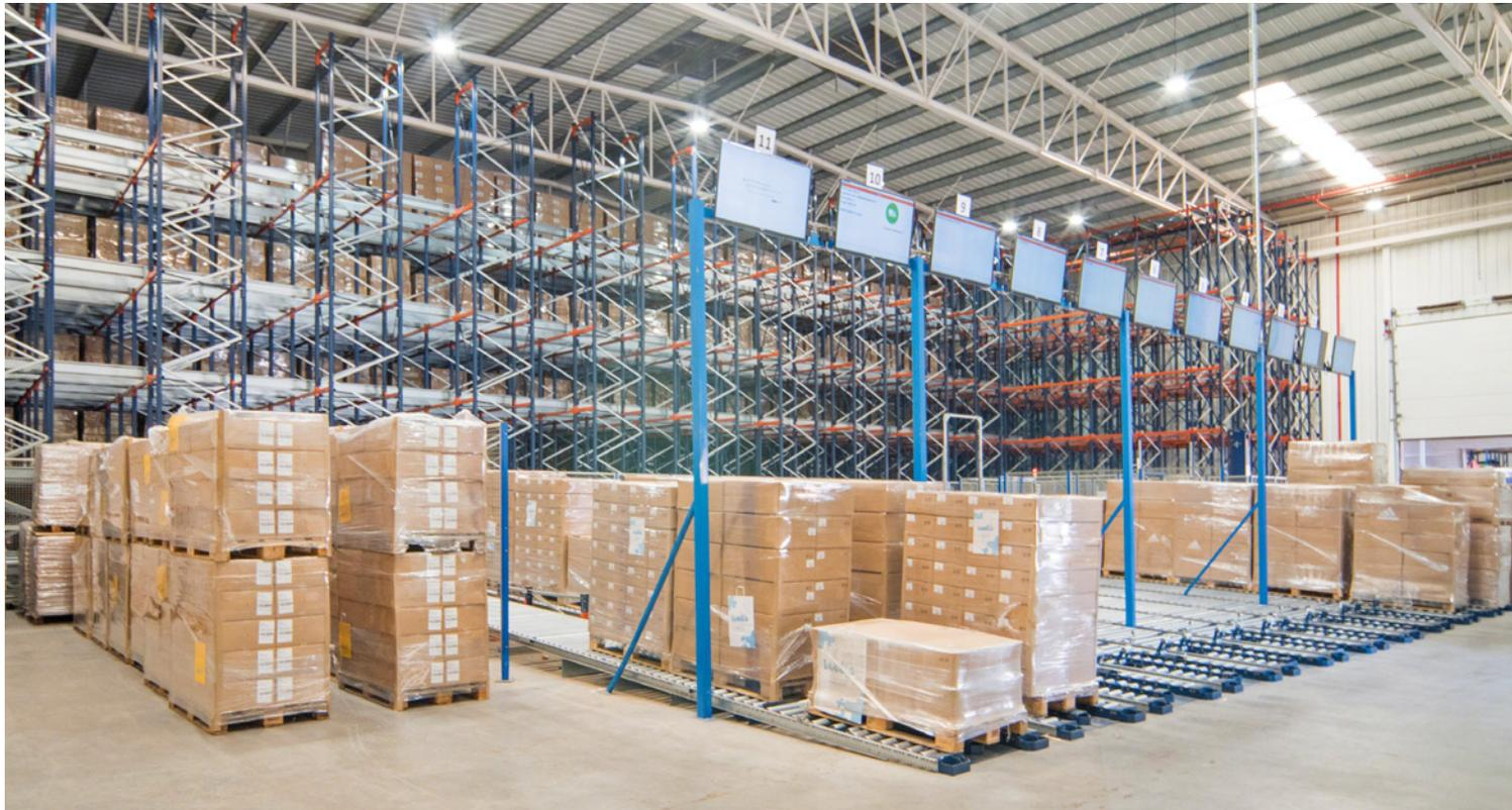
Die schwerkraftgesteuerten Kanäle haben eine leichte Neigung, so dass sich die Paletten durch die Schwerkraft vom höchsten Teil zum niedrigsten Teil, der den Docks zugewandt ist, bewegen. Am Ausgang des Kanals sind die Rollen in zwei Stränge geteilt, so dass die Bediener die Paletten mit Hilfe von Palettenhubwagen entnehmen können.
