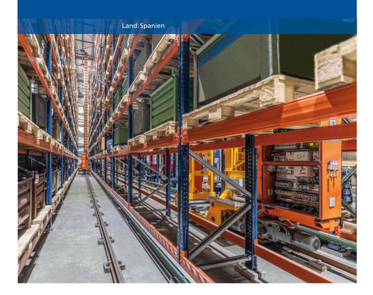
Umgestaltung und Verbesserung sind Teil der DNA des Metallunternehmens Alcorta Forging Group. Ganz in diesem Sinne hat es in seinem Werk in Elgóibar (Baskenland) ein 14 m hohes automatisiertes Lager mit einer Lagerkapazität von 1.115 Paletten in Betrieb genommen. In dem Lager, das vom Lagerverwaltungssystem Easy WMS von Mecalux gesteuert wird, werden täglich 300 Paletten mit ein- und ausgehenden Rohstoffen und Fertigprodukten präzise und sicher bewegt.
