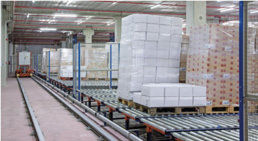
Die Ladevorbereitung eines kompletten LKWs umfasst jeweils drei Kanäle, sodass gleichzeitig die Ladung für acht LKWs bereitgestellt werden kann. Das Shuttle-Car, das zwei Paletten gleichzeitig aufnehmen kann, platziert diese gemäß den Anweisungen von EasyWMS im entsprechenden Kanal.
