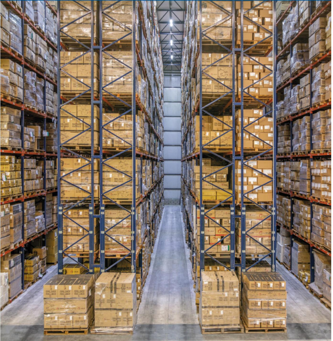
Libus, ein Hersteller von persönlichen Schutzausrüstungen, hat seinen Produktionsstandort in Berazategui, südöstlich von Buenos Aires, durch den Bau eines neuen Hochregallagers in Silobauweise erweitert. In dieser Anlage verwaltet das Unternehmen 2340 Paletten mit Rohstoffen, Halbfertigprodukten sowie Fertigprodukten, die es anschließend an seine Kunden in Argentinien liefert.
