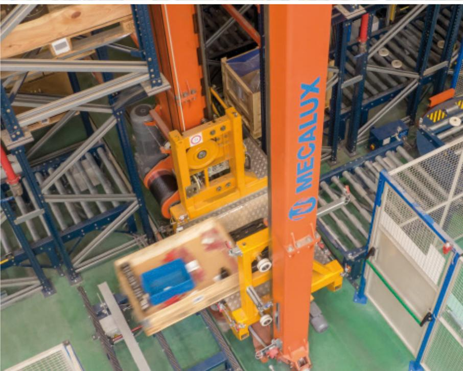
Die Automatisierung hat die Produktivität der Anlagen von JC Valves in Sant Boi (Barcelona) erhöht. Vor Kurzem hat das Unternehmen ein automatisiertes Lager mit einer Lagerkapazität von 3752 Paletten direkt neben den Produktionslinien in Betrieb genommen. Es hat die Aufgabe, die notwendigen Rohstoffe in den Produktionsbereich zu transportieren und gleichzeitig Fertigprodukte aufzunehmen, die für den schnellstmöglichen Versand an die Kunden bereitstehen.
