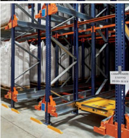
Das neue Lager der Logistikfirma Katoen Natie in Italien besteht aus konventionellen Palettenregalen mit dem halbautomatischen Pallet-Shuttle-System von Mecalux. Diese Regalsysteme nutzen den verfügbaren Raum maximal aus, sodass eine Lagerkapazität von 7765 Paletten erreicht wird. Die Regale sind verstärkt, um die Lagerarbeiter und die Ware bei möglichen Erdbeben zu schützen.
