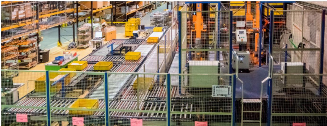
Quer zum Hauptkreislauf wurden zwei Kommissionierstellen in U-Form eingerichtet. Die Auftragszusammenstellung erfolgt nach dem Prinzip „Ware zur Person“, d. h., die Regalbediengeräte bringen die Ware automatisch zu den Kommissionierern.
