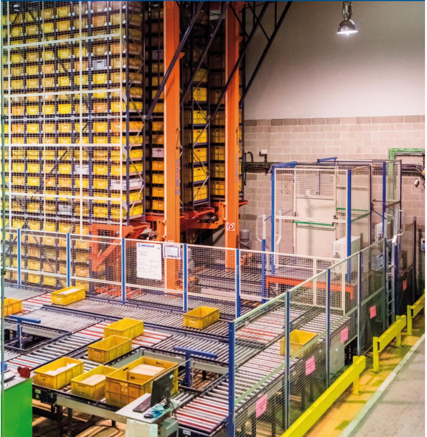
Mecalux hat das Lager von JCH in Barcelona (Spanien) mit einem automatischen Miniload-Lager ausgestattet, das eine Lagerkapazität von 4076 Behältern besitzt. Außerdem wurden ein Förderkreislauf und drei Kommissionierstellen installiert (eine davon dient gleichzeitig zum Auffüllen). Zum Lieferumfang gehört die Lagerverwaltungssoftware Easy WMS, die die höchste Produktivität bei der Auftragszusammenstellung gewährleistet.
