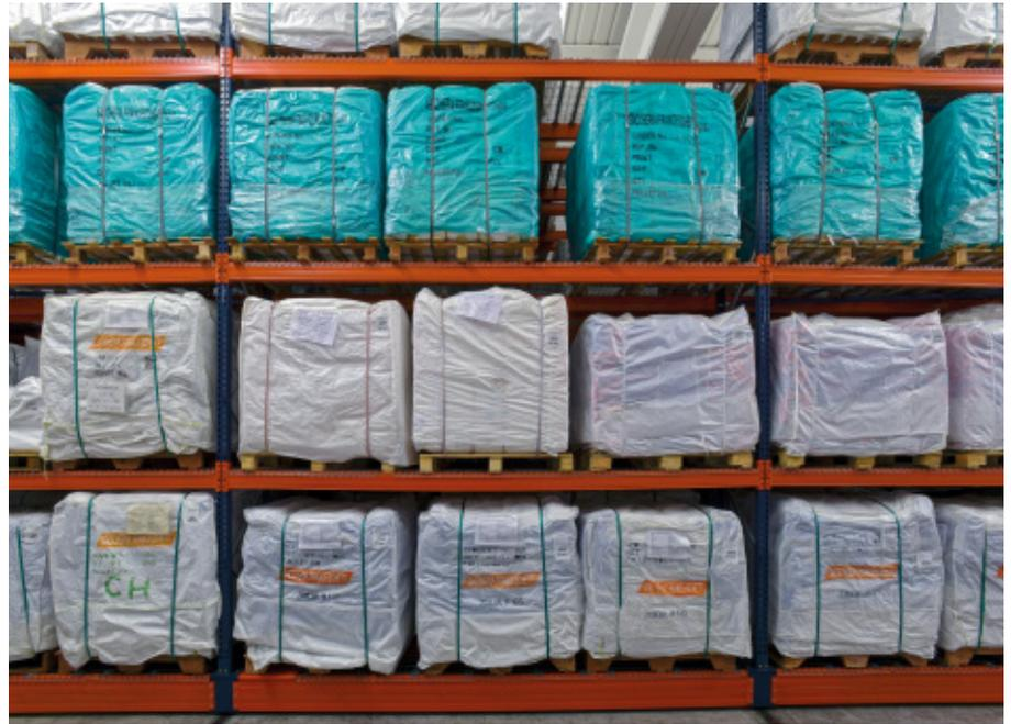
dig seitlich verschieben. Insgesamt wurden sechs doppelte Verschieberegale und zwei feste Regale installiert, eines an jedem Ende des Blocks.
