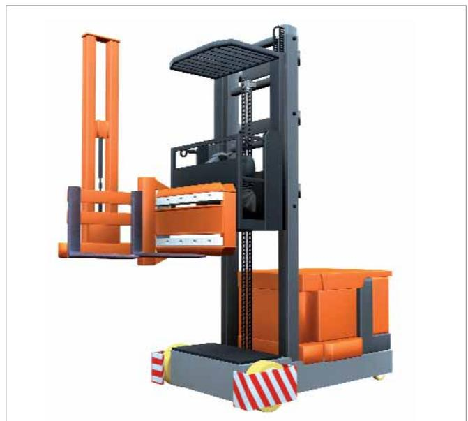
Kommissionierstapler werden innerhalb der Regalgassen mittels Führungssystemen in der Spur gehalten.
