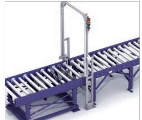
**Paletten-Kontrollstation (PIE).** Zum Fördersystem gehörende Kontrollanlage, die überprüft, ob die Abmessungen der Lagereinheiten den Anforderungen der Förderanlagen entsprechen. Da es sich hier um die erste Kontrolle der Lagereinheit handelt, enthält das System auch ein Barcode-Lesegerät für die Identifikation des Produkts und seine Registrierung im LVS.
