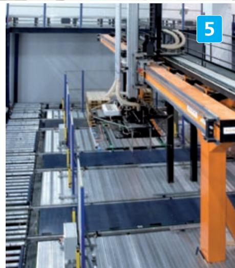
Der Picking-Roboter bereitet Aufträge für Produkte mit hohem Umschlag in Palettschichten vor. Die Paletten werden vollautomatisch mit Regalbediengeräten und Förderanlagen zum Pickingplatz gebracht und von dort abtransportiert.
