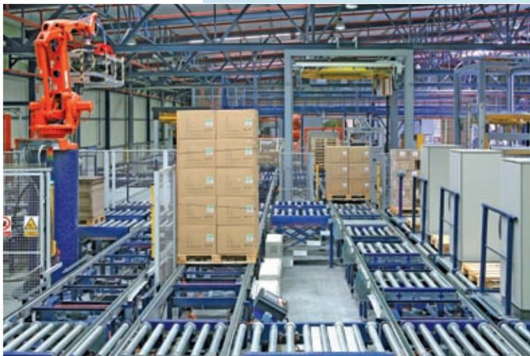
Wenn der Palettenumschlag sehr hoch ist, vor allem bei Artikelnummern mit hohem Umschlag, kann das Picking vollständig mit Robotern automatisiert werden. Diese werden vom LVS gesteuert und bereiten Aufträge gemäß Vorgabe in Palettenlagen oder Behältern vor.
