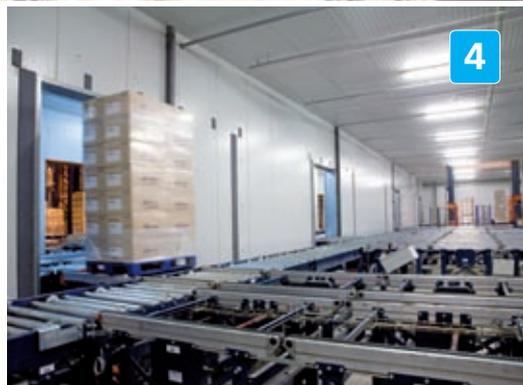
Die Regalstruktur dieses Kühlagers ist selbsttragend, das heißt, die Regale sind gleichzeitig auch die Stützen der Gebäudestruktur
