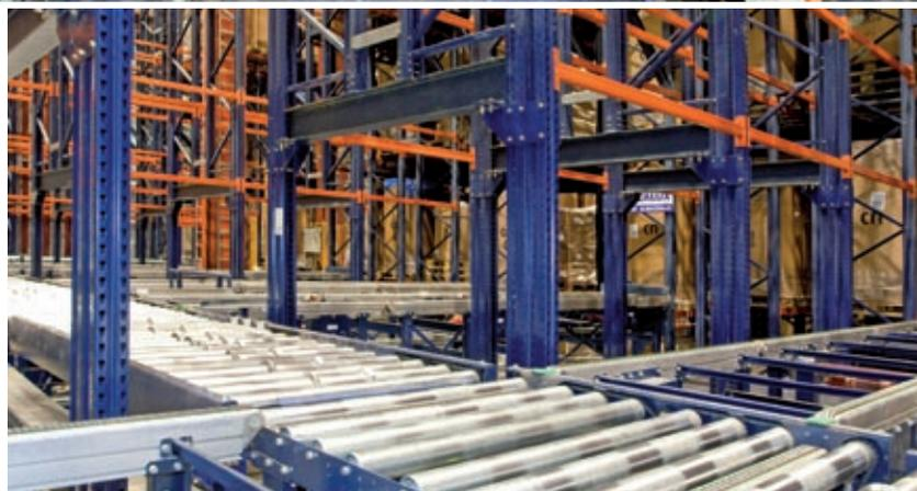
Die Förderanlagen bringen die Paletten von den Laderampen oder aus der Produktion ins Innere der Kühlkammern.
