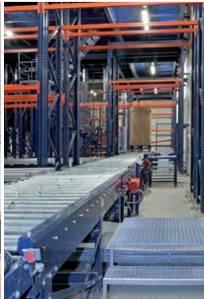
Förderanlagen im Inneren des Kühlslagers
