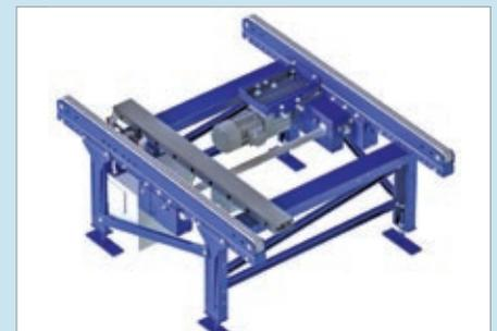
**Kettenförderer (TC).** Palettenförderer für den Transport quer zu den Kufen. Eine ideale Ergänzung für die Rollenförderer, denn eine Kombination aus beiden erlaubt  $90^\circ$ - und  $180^\circ$ -Richtungswchsel und somit das Umlenken bzw. kreisförmige Befördern der Paletten.
