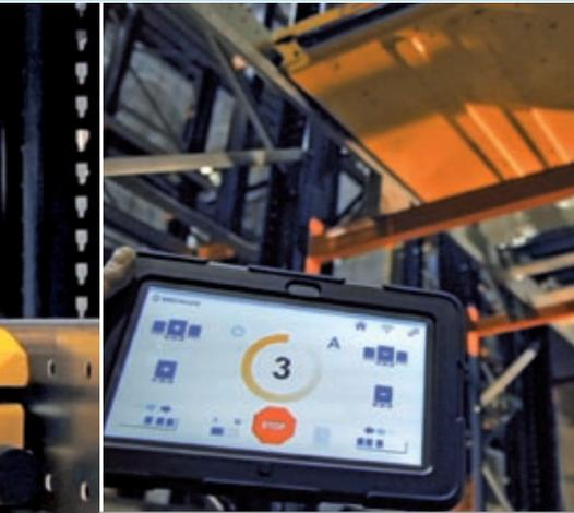
Anwendungsbeispiel für ein Kompaktlager mit dem Pallet Shuttle und jeweils einer Förderanlage am Ein- und Ausgang, wodurch die Arbeitswege und -zeiten der Bediener verkürzt werden.
