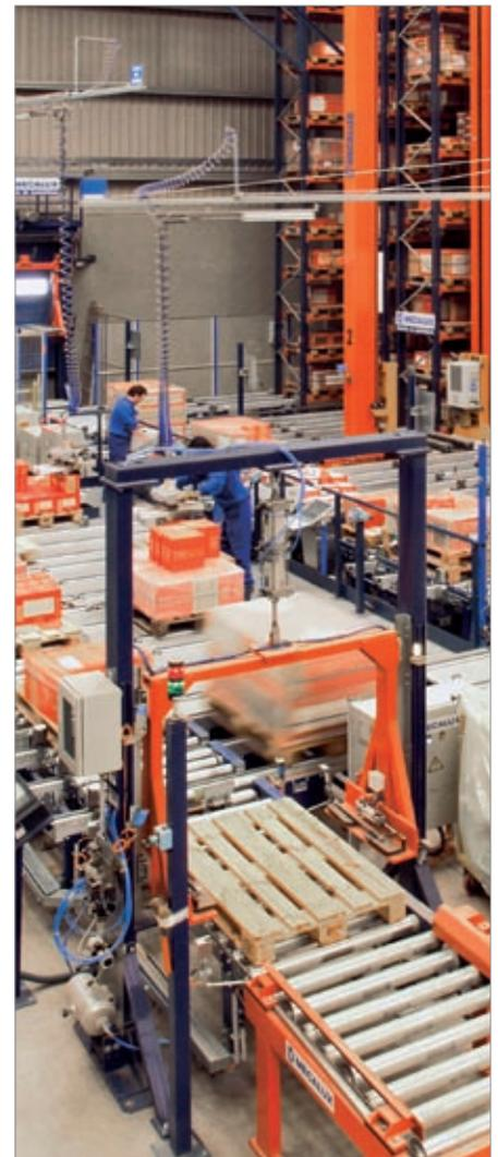
**Palettenstapler.** Ermöglicht das Auflegen von Paletten (meist mit schlechter Qualität) auf Slave-Paletten mit guter Qualität, um Störungen beim Transport und bei der Lagerung zu vermeiden. Er eingesetzt immer in Kombination mit einer Palettenstapel- oder -entstapelvorrichtung.
