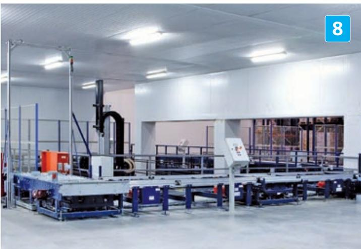
Außerhalb des automatisierten Bereichs werden die Paletten mit Hubvorrichtungen auf Bodenhöhe gebracht, wo sie dann mit Hubwagen bewegt werden.
