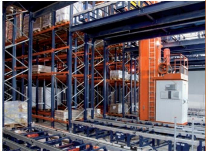
Um den Warenfluss im Bereich des automatischen Pickings zu garantieren, stehen ein Portalroboter mit zwei Achsen, in der Vorzone und automatisierte Förderanlagen zur Verfügung.
