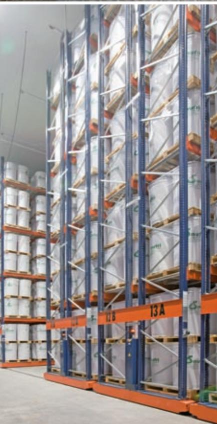
Wenn Movirack-Regale mit verschiebbaren Unterbauten benutzt werden, kann mithilfe einer Option ein Gang mit der jeweils für das Picking erforderlichen Breite geöffnet werden.
