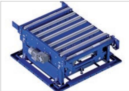
**Kettenausschleuser.** Ermöglicht einen Richtungswechsel von 90° beim Befördern der Ladung. Einlauf der Ladung vom Rollenförderer und Auslauf auf dem Kettenförderer oder umgekehrt. Das Umsetzen erfolgt über einen fest installierten Rollenförderer und einen Kettenförderer, der mithilfe eines Exzenters angehoben werden kann.
