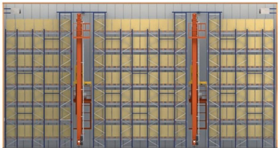
Das System erlaubt die kompakte Blocklagerung von Paletten, Behältern oder Gitterboxen mit verschiedenen Breiten.
