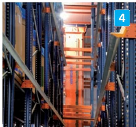
Im Pufferbereich werden fertig vorbereitete Aufträge bis zum Zeitpunkt ihres Versands aufbewahrt. In diesem Bereich werden die Paletten von einem Regalbediengerät bewegt.
