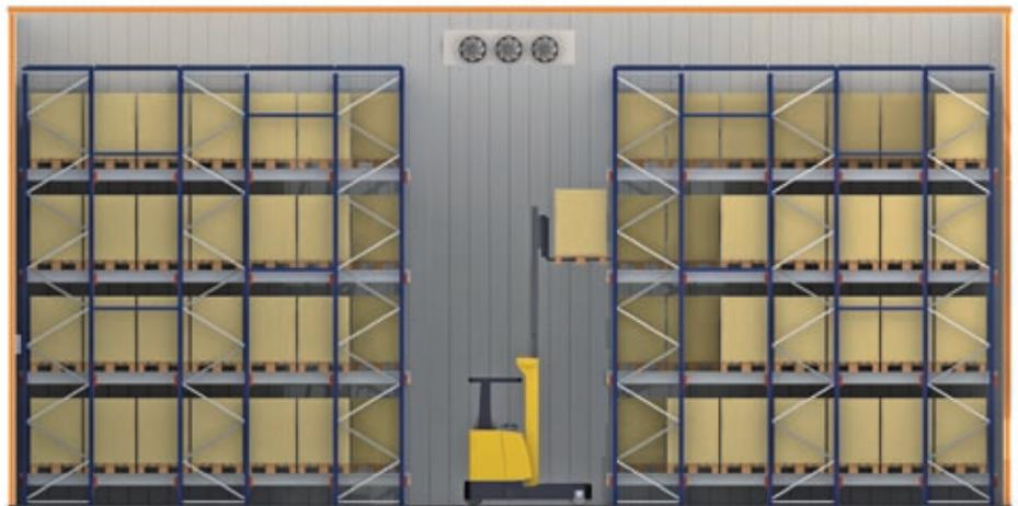
Die Halbautomatik der Kompaktlagerung mit dem Pallet Shuttle ermöglicht eine schnelle und präzise Lagerung der Waren. Der Stapler stellt die Last auf die Schienen und der Pallet Shuttle befördert sie zum zugewiesenen Lagerplatz. Der Bediener gibt die Befehle für die Ein- und Auslagerung der Waren mit Hilfe einer Fernbedienung.
