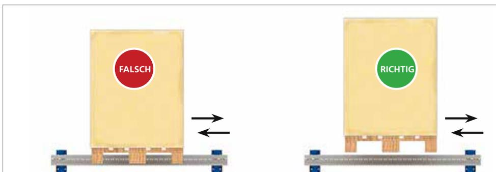
Abb 10. Die Paletten nicht über die Tragschiene schleifen
